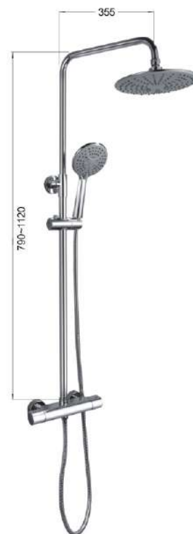
F-5151 溫控淋浴花灑龍頭組(無下出水) 牌價：$22,800。 建議冷熱水管離地安裝高度1100mm
